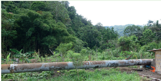
Eine Pipeline zum Abtransport von verunreinigten Gestein aus dem Minenbau – die Entsorgung erfolgt im Meer
