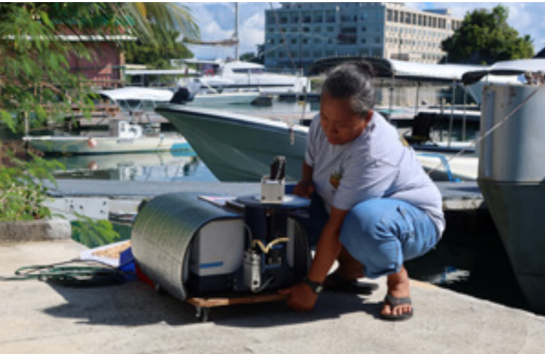
Sharon Patris von der Coral Reef Research Foundation beim Aufbau des mobilen Spektrometers zur Messung der CO 2 Konzentration. Foto: Justus Notholt
