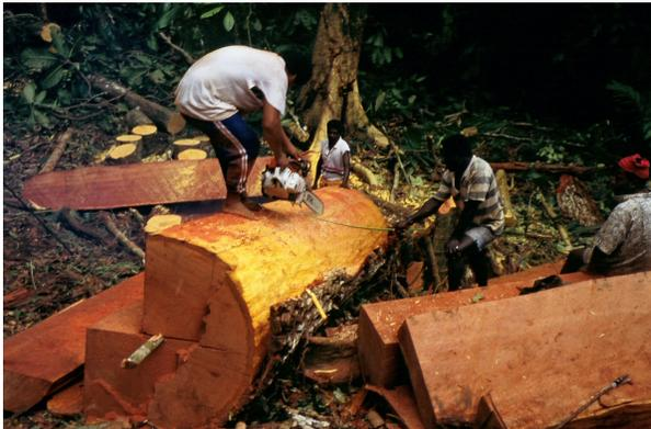
Freihändiges Aufschneiden eines Baumstammes mit Hilfe einer Kettensäge.
